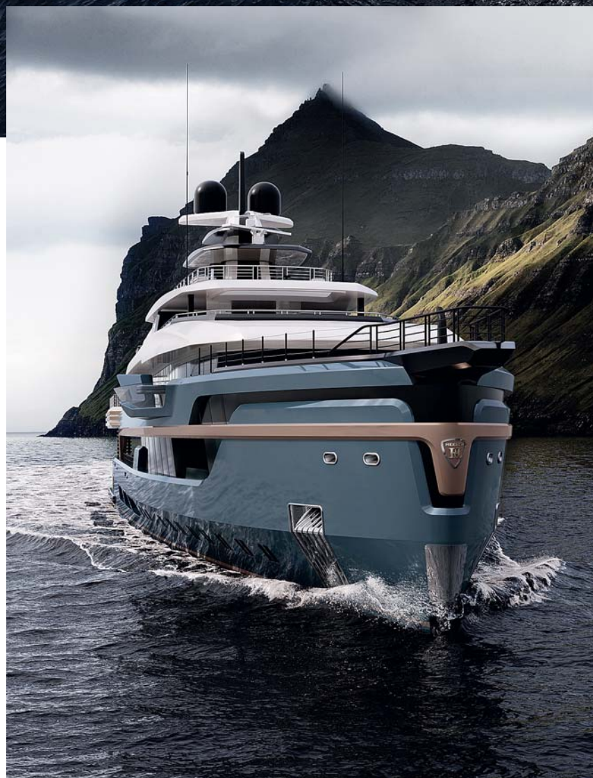
Надстройка выросла на два яруса — скайлаунж и «воронье гнездо». На носу вытянулся бушприт с леерным ограждением.
